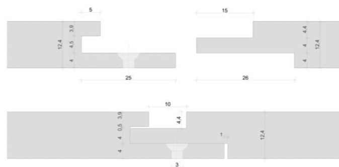
Rys. 4. Zamek połączeniowy pióro-wpust elementu dekoracyjnego grubości 12,4 mm. Wymiary podano w mm Fig. 4. Tongue and groove joint of decorative element 12.4 mm thick. Measurements given in mm Рис. 4. Соединительный замок шип-паз декоративного элемента толщиной 12,4 мм.
